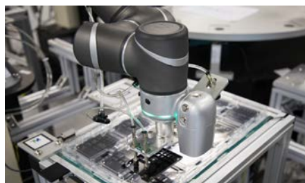
Manipulation et assemblage de composants avec Cobot TMS et sa vision intégrée
