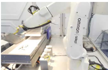
Service machine, alimentation de pièces en vrac par Anyfeeder et caméra / Chargement de machine par Robot 6 axes Viper
