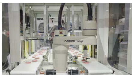
Pick and Place haute cadence par Scara En tracking – repérage des pièces par caméra
