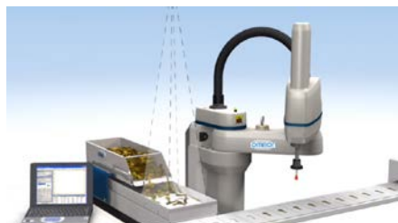
Alimentation de pièces par Anyfeeder et caméra – Picking par robot Scara
