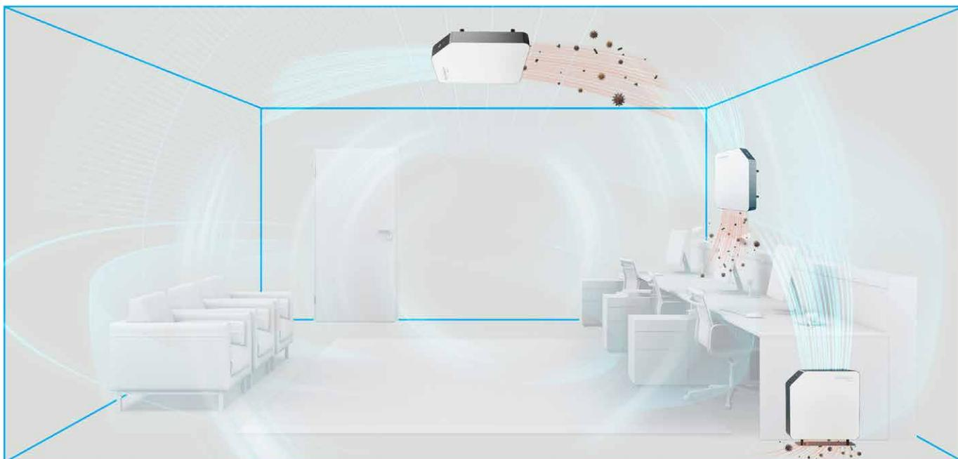
Le graphique montre trois lieux d'installation possibles à titre d'exemple. SteriWhite Air Q assure une circulation permanente de l'air dans la pièce fermée de manière à atteindre une inactivation maximale des virus, bactéries et spores de moisissures transportés par les aérosols.
