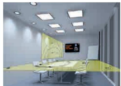
Environ 450 lux sont obtenus au niveau de l'œil de l'utilisateur. Support optimal du système biologique de l'utilisateur.
