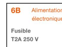
Insérez un fusible (250V, T2A) selon schéma 5A ou 5B
