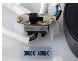
2. Sélectionnez la température de couleur à l'aide de l'interrupteur CCT
