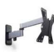
EXO 200TW3 support mural aluminium inclinable de +/- 15DEG et orientable de +/- 180 DEG. Déport 410 mm - 2 bras, pour écran de 19' à 43', vesa 50 à 200x200. Poids maximum supporté 15 kg.
