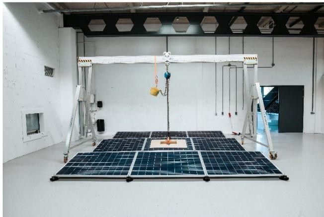
Les mesures de la charge du vent ont été effectuées et élaborées conformément à la recommandation CUR C103 « Études en soufflerie des charges de vent sur les bâtiments (de grande hauteur) » et au projet de norme NEN 7250 :2014 « systèmes Énergie solaire - intégration dans les toitures et façades - aspects du bâtiment ».
