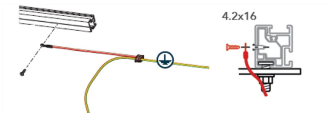
Figure 11 : Câble de liaison équipotentielle des rails
