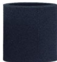
Préfiltre mousse pour filtre CFP D=int : 117mm, D= ext : 157mm, hauteur : 200mm. La double filtration est située au-dessus de l'entrée des poussières épure l'air rejeté et non l'air aspiré. A laver simplement.
