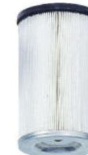
Filtre cartouche lavable D= int : 70mm, D= ext : 117mm, hauteur : 197mm. La double filtration située au-dessus de l'entrée des poussières épure l'air rejeté et non l'air aspiré . A dépolluer à sec ou à l'eau selon utilisation.
