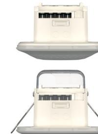
Détecteur de présence blanc 360°. IP 54. Contact renforcé 10 A. LED = max 400W. Montage encastré plafond. Détection Diamètre 10 m à 2.5 m de haut. Réglage TEMPO 15 sec-30 min + impulsion. Réglage possible via télécommande.
