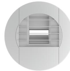
Bouche alizé hygro à modulation de débit de 10 à 40 m<sup>3</sup>/h suivant l'hygrométrie de la salle de bains, D80 mm
