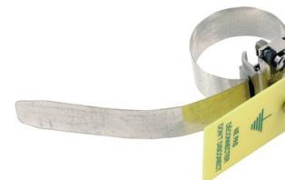
Collier de mise à la terre 2.5-16 mm<sup>2</sup> 200 mm 17.5-48 mm (x 7) avec signalisation idéal pour mise à la terre des conducteurs. Livré avec plaquette de mise en garde 'Ne pas déconnecter' (non montée). Acier inoxydable.
