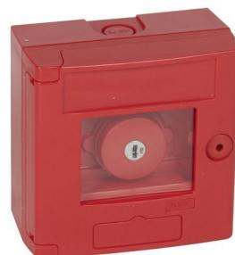
Coffret bris de glace coup de poing à accrochage IP44 rouge classe II IK07 - déverrouillage par clé n°850 - montage en saillie - conforme à la norme NF C 15-100
