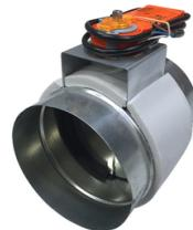
Registre motorisé en acier galvanisé diamètre 200 mm - étanche et isolé - avec servomoteur extra-plat 230 volts, tout-ou-rien - 3 points, permettant la motorisation d'un volet de réglage et le calage du débit d'air maxi et mini
