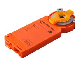
Servomoteur extra-plat 24V volts, tout-ou-rien - 3 points, permettant la motorisation d'un volet de réglage et le calage du débit d'air maxi et mini - câble d'alimentation inclus - garantie 5 ans
