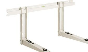
Support mural réglable P465xH400xL800mm avec crochet en acier zingué et peint à la poudre polyester RAL 9002 blanc. Charge certifiée 160kgs. Niveau, butée de réglage, vis, chevilles et rondelles anti-vibration incluses.
