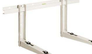
Support mural réglable P550xH400xL800mm avec crochet en acier zingué et peint à la poudre polyester RAL 9002 blanc. Charge certifiée 160kgs. Niveau, butée de réglage, vis, chevilles et rondelles anti-vibration incluses.
