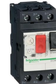
TeSys - disjoncteur moteur magnéto-thermique GV2ME - 3P - commande par bouton poussoir - réglage th. 1.6 à 2.5A - moteur : 0.75kW à 400/415 V CA 50/60 Hz - courant déclench. magnétique 33.5 - borniers à vis-étrier
