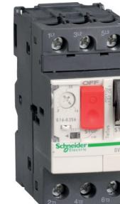
TeSys - disjoncteur moteur magnéto-thermique GV2ME - 3P - commande par bouton poussoir - réglage th. 1 à 1.6A - moteur : 0.37/0.55kW à 400/415 V CA 50/60 Hz - courant déclench. magnétique 22.5 - borniers à vis-étrier
