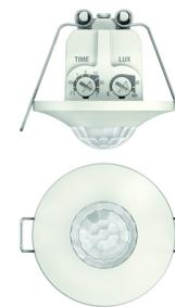
Mini DéTECTeur de mouvement blanc 360°. IP 55. Contact renforcé 10 A. LED = max 400W. Montage encastré plafond. Détection Diamètre 8 m à 2.5 m de haut. Réglage TEMPO 30 sec-30 min + impulsion.
