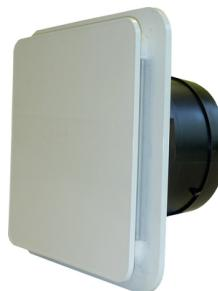
Bouche d'extraction et d'insufflation plastique réglable extra-plate. Débit de 45 à 150 m<sup>3</sup>/h. 4 volets pour orientation du jet d'air horizontal ou vertical. Manchette PVC à griffes diamètre 125 mm
