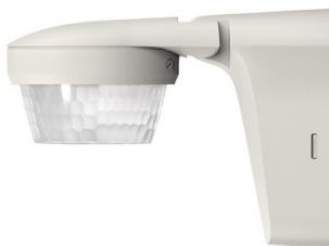
Détecteur de mouvement blanc pour installation extérieure. Angle de détection 360°, Diamètre ør 32 m à 2.5m de haut. IP66. Contact alimenté 10A. Coupe lampe LED max 500W. temporisation 1 sec à 20 min.
