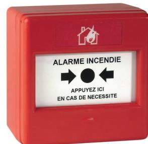
S3000 - Déclencheur Manuel Conventionnel (DM) - Boîtier rouge Incendie - Montage saillie - Membrane déformable - IP21 - Livré avec clé de réarmement - Certifié CE CPD et NF
