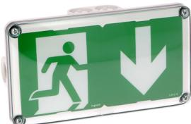
BAES d'évacuation saillie étanche à LEDs 45 lumens 1 heure IP66 IK10 plastique/inox SATI Adressable avec fonction Visibilité Augmenté et balisage lumineux d'évacuation pour ERP et ERT - certifié NF Environnement et NF AEAS Performance SATI
