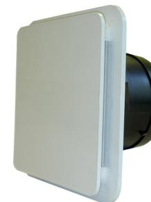
Bouche d'extraction et d'insufflation plastique réglable extra-plate. Débit de 15 à 50 m<sup>3</sup>/h. 4 volets pour orientation du jet d'air horizontal ou vertical. Manchette PVC à griffes diamètre 80 mm
