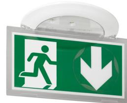
BAES d'évacuation encastré Kickspot à LEDs 45 lumens 1 heure IP40 IK04 SATI Connecté - avec batteries Ni-Cd - fourni avec étiquette universelle repositionnable et recyclable - visualisation de l'état sur l'application Legrand ERPconnecté
