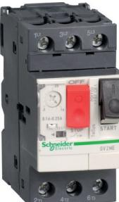
TeSys - disjoncteur moteur magnéto-thermique GV2ME - 3P - commande par bouton poussoir - réglage th. 4 à 6.3A - moteur : 2.2kW à 400/415 V CA 50/60 Hz - courant déclench. magnétique 78A - borniers à vis-étrier
