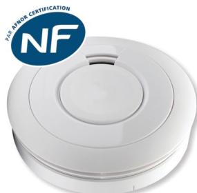
DAAF (Pack Chantier-Vrac) Pile Lithium scellée 10ans inamovible. Certifié EN14604 et NF292. Technologie ACP d'auto-compensation à la poussière. Grille anti-insecte 0,8mm. Grand bouton TEST. Fonction silence. Protection antivol.
