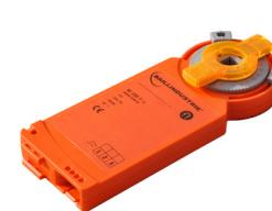
Servomoteur extra-plat 230 Volts, tout-ou-rien - 3 points, permettant la motorisation d'un volet de réglage et le calage du débit d'air maxi et mini - câble d'alimentation inclus - garantie 5 ans
