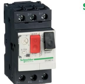
TeSys - disjoncteur moteur magnéto-thermique GV2ME - 3P - commande par bouton poussoir - réglage th. 6 à 10A - moteur : 3/4kW à 400/415 V CA 50/60 Hz - courant déclench. magnétique 138A - borniers à vis-étrier
