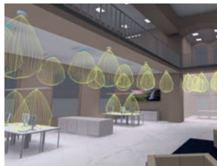
Vue 3D d'un disposition de détecteurs et de luminaires pour atteindre le niveau d'éclairement souhaitée.
