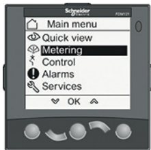
Afficheur FDM121 : navigation.
