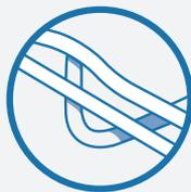
Bord de sécurité soudé en T (système breveté) et fils de forme arrondie pour sécuriser la pose et le tirage des câbles (pour les largeurs à partir de 100 mm).
